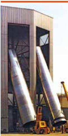
**6** 30 Meter hoher Montageturm für den Zusammenbau von Silos
