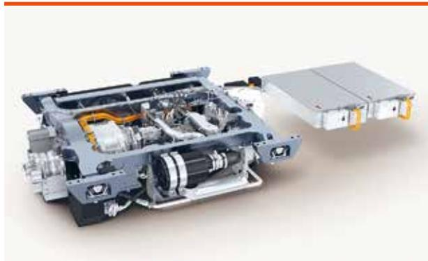
**4** Triebwagenantrieb MTU Hybrid Power Pack
